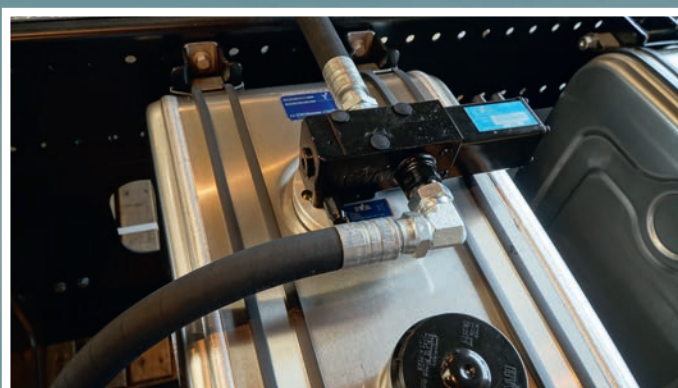
Zawór montowany na niskim filtrze powrotnym
