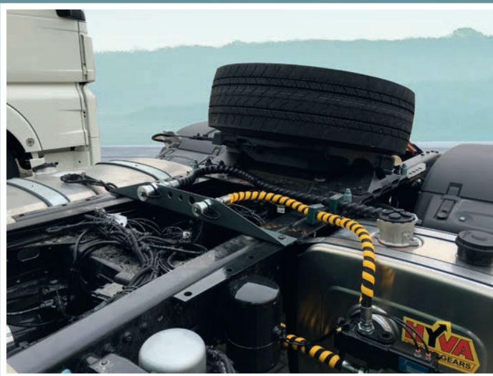
Belka z szybkozłączami do hydrauliki dwuobwodowej
