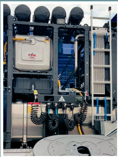
Hydraulika za kabiną ciągnika czteroosiowego
