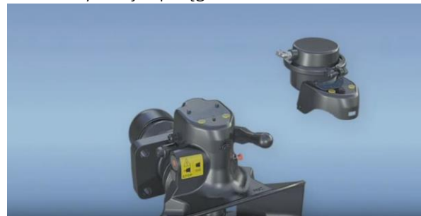
Modyfikacja sprzęgu 5050A na 5050AM
