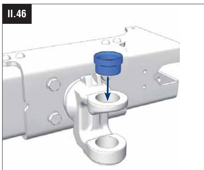
Montage der oberen Führungsbuchse (1) Fitting of the upper guide bushing (1)
