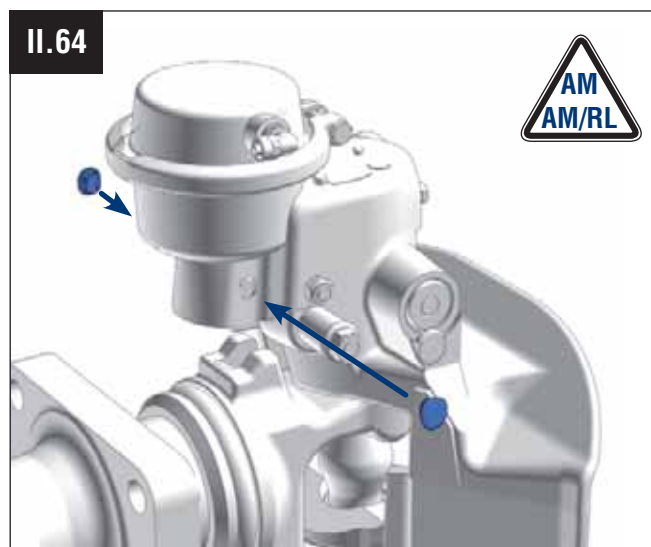
Spiralspannstift eintreiben (2) Drive in spiral pin (2)
