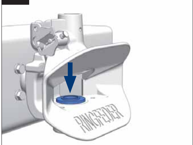
Montage der unteren Führungsbuchse (4) Fitting of the lower guide bushing (4)
