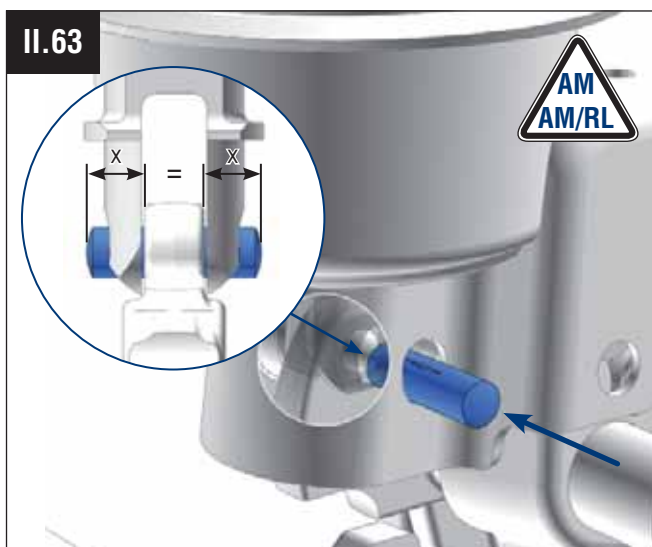
Spiralspannstift eintreiben (1) Drive in spiral pin (1)
