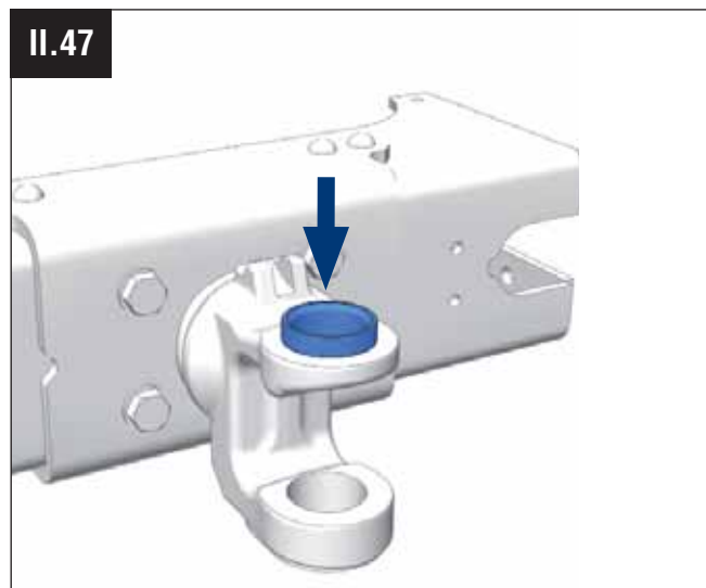
Montage der oberen Führungsbuchse (2) Fitting of the upper guide bushing (2)
