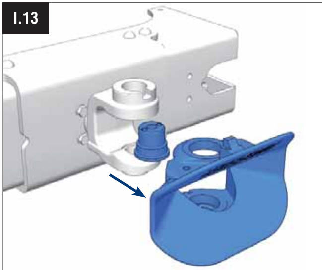
Demontage der unteren Führungsbuchse und des Kuppelkörpers (4) Dismantling of the lower guide bushing and the coupling assembly (4)
