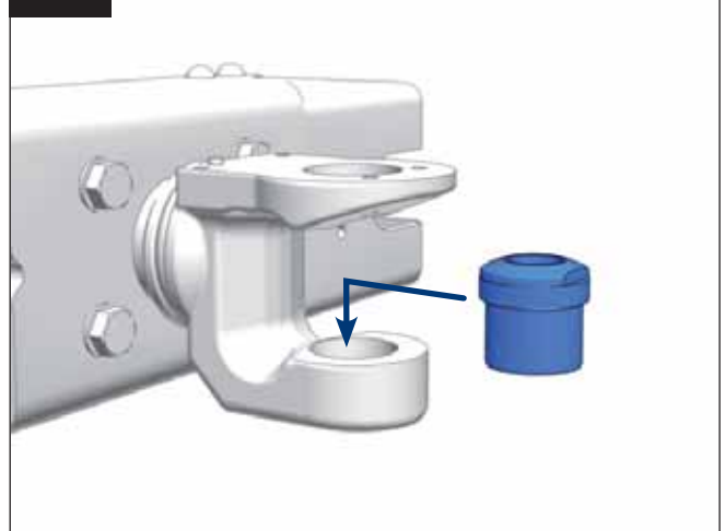
Montage der unteren Führungsbuchse (1) Fitting of lower guide bushing (1)
