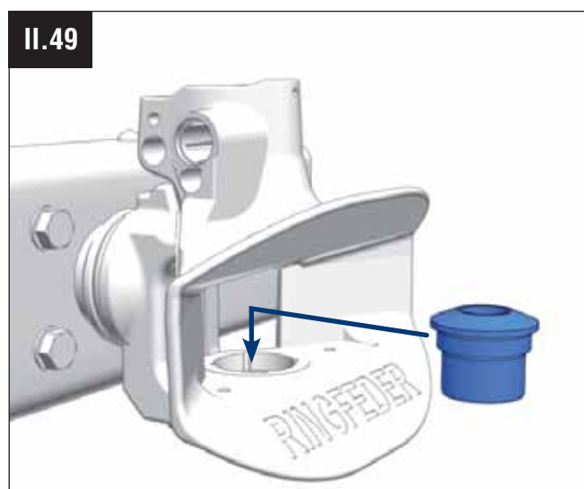
Montage der unteren Führungsbuchse (1) Fitting of the lower guide bushing (1)
