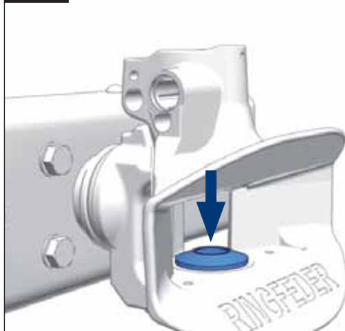
Montage der unteren Führungsbuchse (4) Fitting of the lower guide bushing (4)
