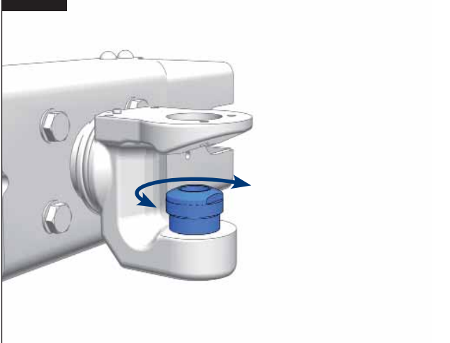
Montage der unteren Führungsbuchse (2) Fitting of lower guide bushing (2)
