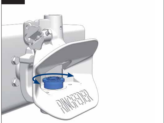
Montage der unteren Führungsbuchse (2) Fitting of the lower guide bushing (2)
