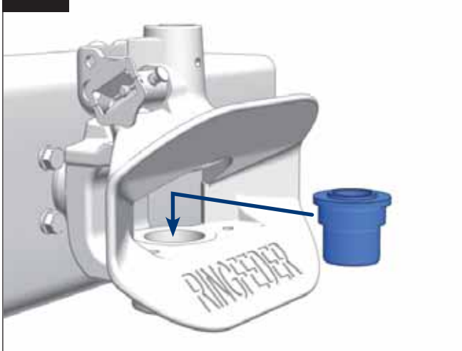
Montage der unteren Führungsbuchse (1) Fitting of the lower guide bushing (1)
